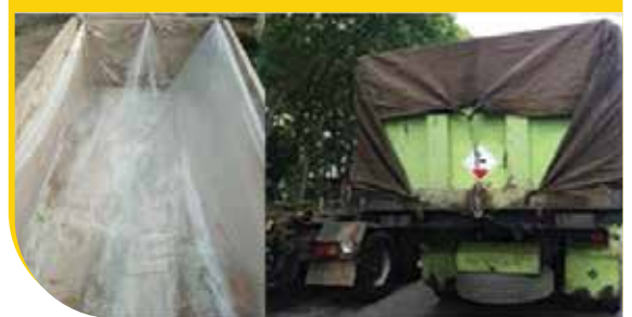
Terpal dan liner box
